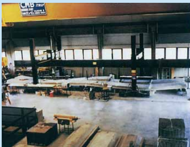
Prove sperimentali condotte dal Prof. Franco Levi presso il Politecnico di Torino sul solaio alveolare dal 1983 al 1986.
