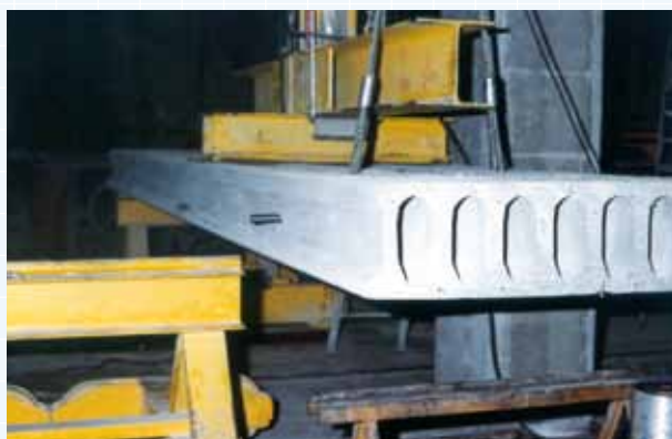
Solaio alveolare RAP H=36 cm, sotto carico in laboratorio GCN per verifica del sistema di sollevamento e posa in opera mediante funi spinotti in acciaio.
